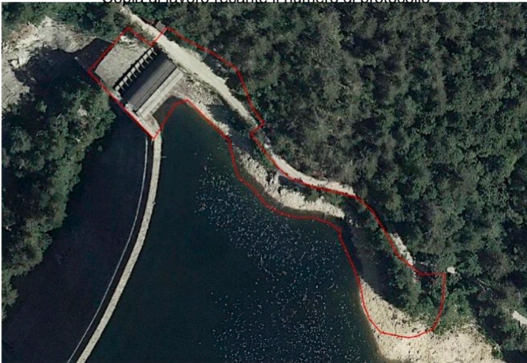
Fig. 4: Ortofoto dell'area di cantiere - perimetro rosso in figura (Comune di Campomorone, GE). Come specificato nella Relazione Generale (pag. 6), l'opera "(...) Si propone pertanto di realizzare, sfruttando l'area attualmente occupata dai sifoni in sponda destra (la cui quota di innesco non risulta più compatibile con le quote di esercizio dell'invaso ma le cui quote di fondazione sono compatibili con la quota di sfioro da trapiantare), una soglia di scarico costituita da un canale in calcestruzzo armato a sezione rettangolare (...)".
