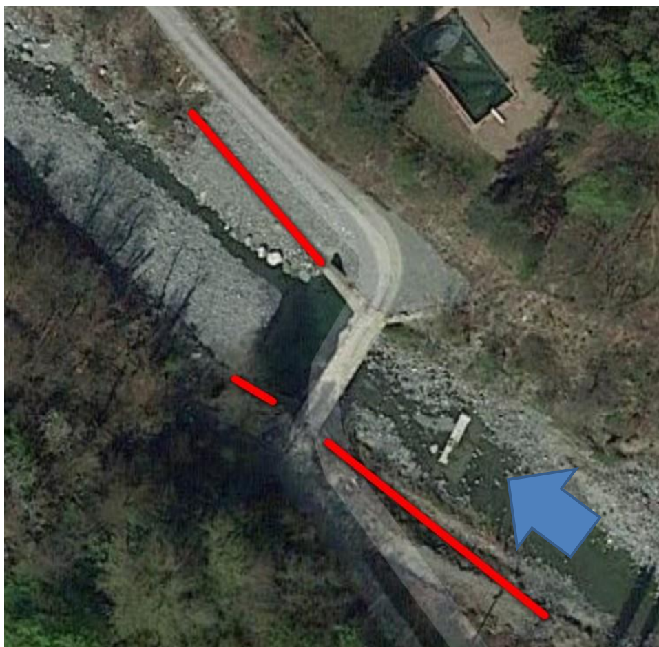
Fig. 2: porzioni di sponde interessate dalla realizzazione delle difese spondali in prossimità del ponte che conduce al Villaggio Primavera (Studio di incidenza ambientale, pag. 5)
